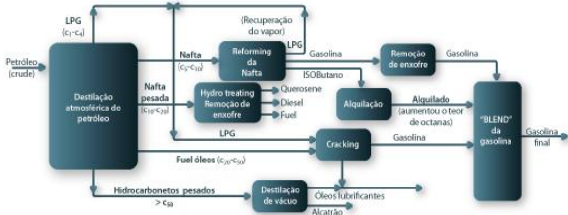
Figura 2: Esquema Simplificado de uma Refinaria Fonte: Universidade de Coimbra (2007)
